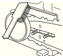
Регулярно проверяйте, чтобы лента тормоза была по крайней мере толщиной минимал 0,6 мм в самом изношенном месте.
