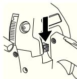
**ПОМНИТЕ!** Выключатель Запуск/Остановка автоматически переходит рабочее положение. В целях избежания непроизвольного запуска, головка свечи должна быть всегда снята со свечи когда вы оставляете машину без присмотра.
