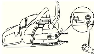
Цепь считается натянутой правильно, если она свободно проворачивается рукой. После этого , удерживая носок пильного полотна в верхнем положении, затяните гайки крепления пильного полотна универсальным ключом.
