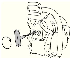
В некоторых глушителях предусмотрен специальный искрогаситель. Если ваша машина оборудована таким глушителем, сетку фильтра следует чистить раз в неделю. Наилучшие результаты дает чистка стальной щеткой. Забитая решетка приводит к работе с горячим двигателем, что дает серьезные повреждения двигателя.
