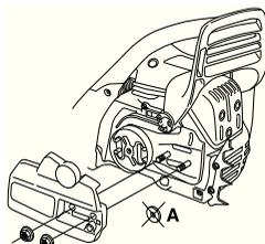
Установите пильное полотно на специально предназначенные болты. Установите полотно в самое заднее положение. Наденьте цепь на ведущую звездочку и вставьте ее хвостовики в паз пильного полотна. Начинать с верхней стороны пильного полотна.
