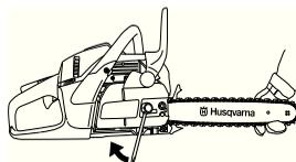
При установки новой цепи следует часто проверять ее натяжение , пока цепь не приработается. Регулярно проверяйте натяжение цепи. Регулярно проверяйте натяжение цепи. Правильно натянутая цепь обеспечивает высокое качество пиления и долгие служит.
