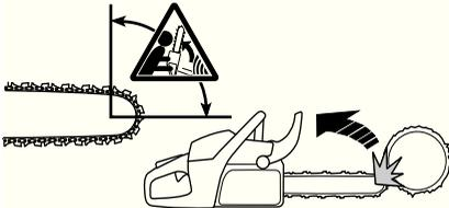
Отдача всегда происходит в плоскости резания пилы. Обычно при отдаче моторную пилу отбрасывает назад и вверх в направлении рабочего. Тем не менее моторная пила в момент отдачи может двигаться в различных направлениях в зависимости от метода резки, который применялся в момент касания зоны отдачи полотна и объекта.
