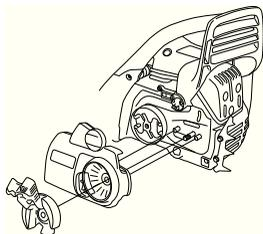
Установите пыльное полотно на специально предназначенные болты. Установите полотно в самое заднее положение. Оденьте цепь на ведущую звездочку и вставьте ее хвостовики в паз пыльного полотна. Начинать с верхней стороны пыльного полотна.
